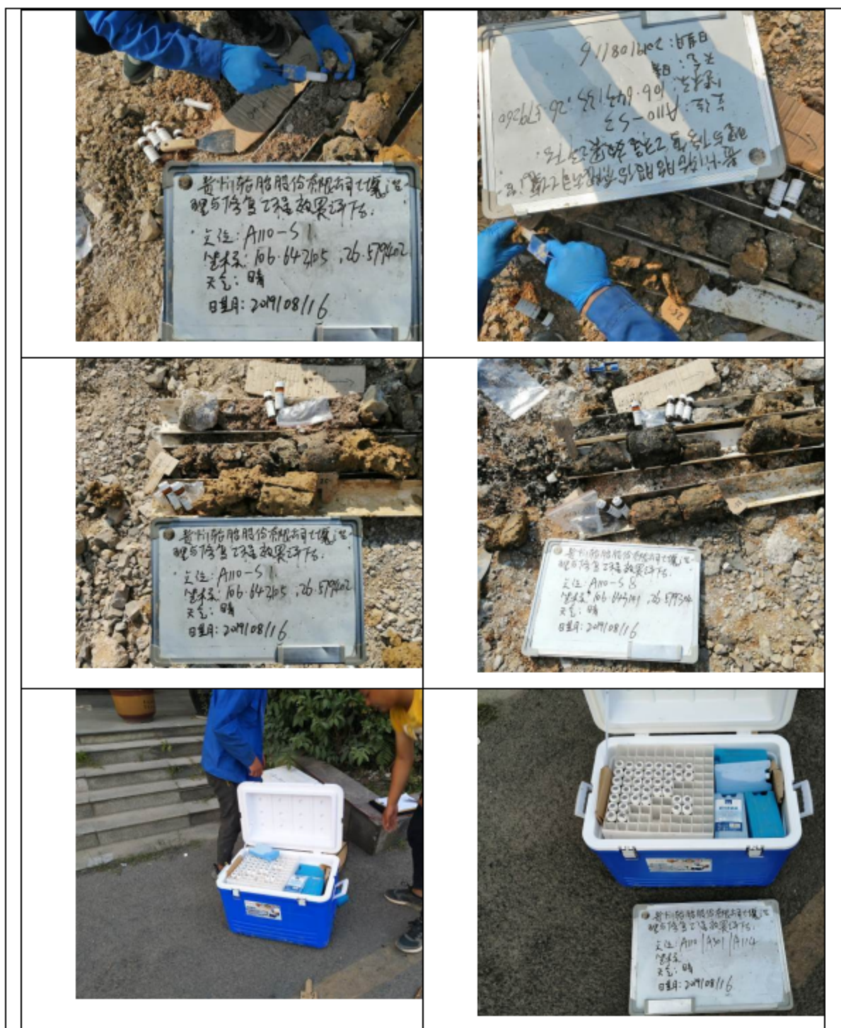
图 5-1 基坑土壤样品采集现场照片
