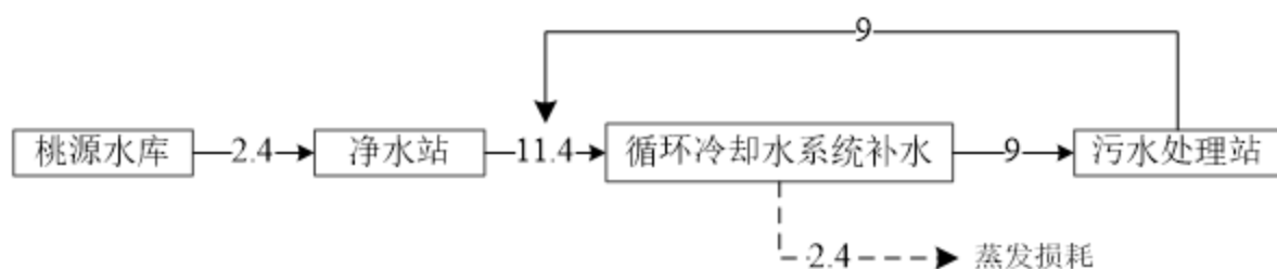
图 2.1-7 本项目水平衡图 单位: \text{m}^3/\text{d}
